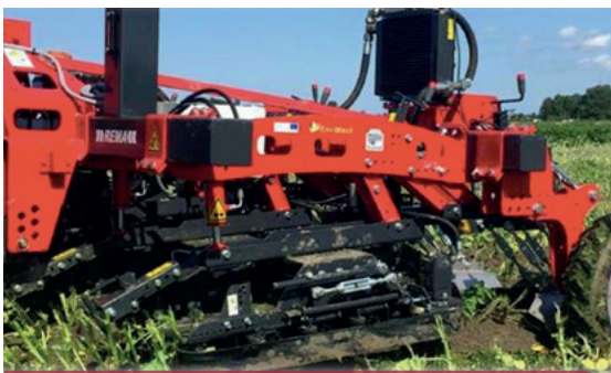
> Arrache-fanes à bandes Rema EnviMaxX - Vue de détail des bandes arracheuses et des palettes de maintien des buttes.
