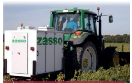
> Équipement Xpower de Zasso avec un générateur électrique à l'arrière du tracteur, relié au caisson « applicateur » situé à l'avant
